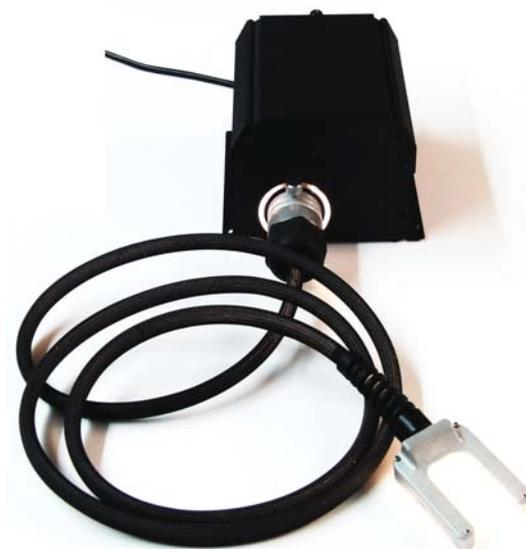
El lector de venas consiste en un generador de luz, especialmente diseñado para el equipo, un cable de fibra óptica y un cabezal en forma de herradura que alberga los puntos de fibra.
